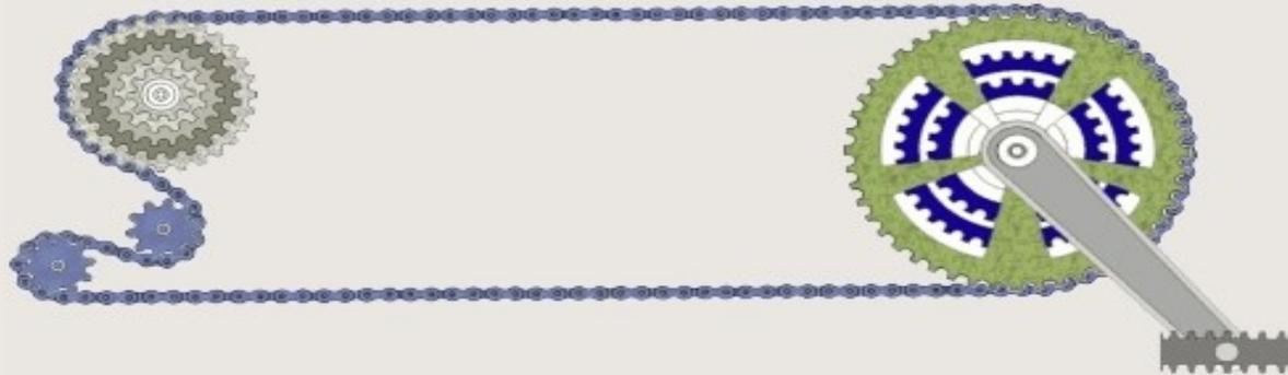
Le système de transmission permet de donner le mouvement de rotation à la roue arrière. Il transmet le mouvement de rotation
