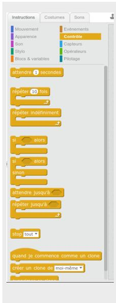
Les instructions de contrôle permettent de réaliser une attente, des répétitions et des conditions.
