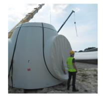
Le moyeu est une pièce en acier moulé. Il supporte les pales et relie le rotor à la nacelle. Il fait varier l'angle d'attaque des pales simultanément.
