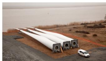
Elles transfèrent la puissance du vent au moyeu du rotor. Dimensions et tailles: jusqu'à 40m de longs et plus de 2,5 m de diamètre. Matériaux: fibre de verre.
