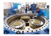
Il sert à élever la vitesse de rotation entre l'arbre primaire et l'arbre secondaire qui entraîne la génératrice électrique. En effet, la faible vitesse de rotation de l'éolienne ne permettrait pas de générer du courant électrique dans de bonnes conditions avec les générateurs de courant classiques. L'arbre secondaire comporte généralement **un frein mécanique** qui permet d'immobiliser le rotor au cours des opérations de maintenance et d'éviter l'emballement de la machine.
